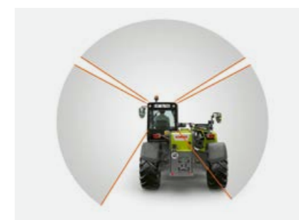
Niezakłócony widok na tył dzięki nisko ułożonemu ramieniu teleskopowemu – dla większego bezpieczeństwa pracy
