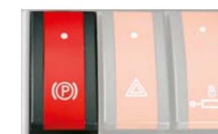
Ręczna aktywacja hamulca postojowego jest możliwa przełącznikiem.
