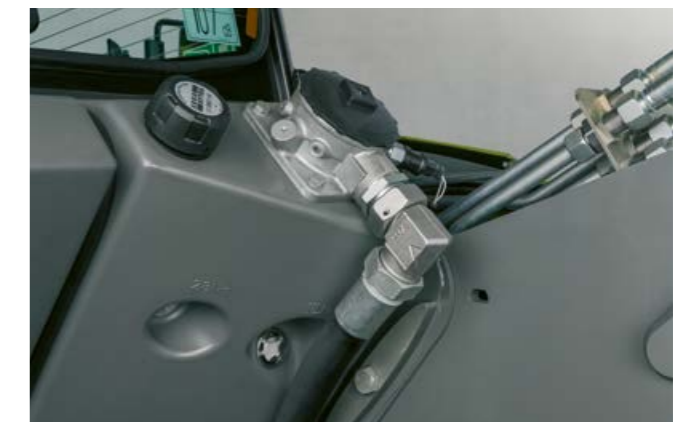
Poziom oleju hydraulicznego można wygodnie kontrolować przez wziernik. Instalacja hydrauliczna jest chroniona filtrem powrotnym, który należy wymienić dopiero po 1000 godzin pracy.
