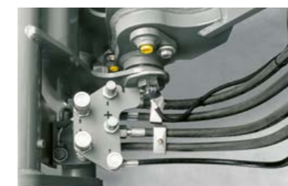
Przyłącza hydrauliki bezpiecznie umieszczone na ramce narzędzi
