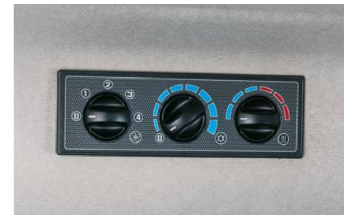
Obsługa układu wentylacji jest łatwo dostępna z prawej strony w podsufitce.
