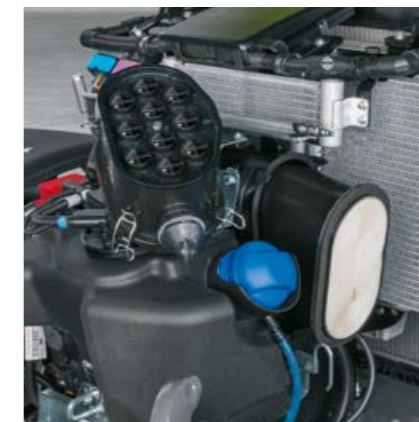
Filtr powietrza PowerCore® jest łatwo dostępny z przodu pod maską silnika – dzięki niemu zmniejsza się częstotliwość czyszczenia.
