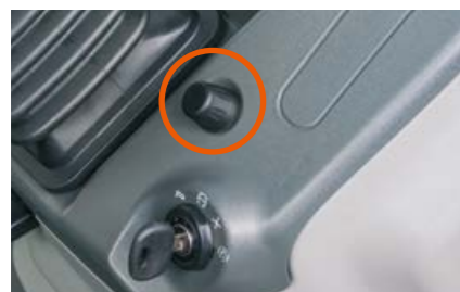
Ulokowane obok kolumny kierownicy pokrętko umożliwia komfortową nawigację w menu.
